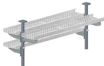
Le placement des consoles sur le pendent est limité à un maximum de 3 consoles (avec une charge maximale de 20daN/m par chemin de câble, donc 3x20daN/m par pendent).
