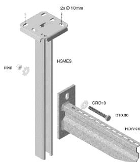
La console **HDWKM** est vissée à travers le pendent au moyen d'un boulon **B10.80**, de 2 rondelles plates **RO10** et d'un écrou **M10**.
