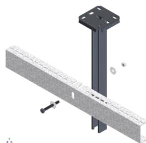
La console **DKBS** est vissée à travers le pendard au moyen d'un boulon **B10.80**, de 2 rondelles plates **CRO10** et d'un écrou **M10**.
